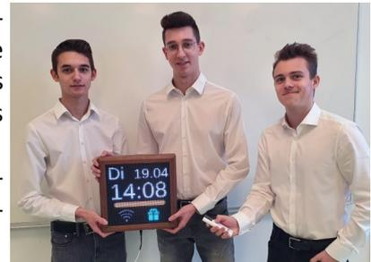
Der ClassMate kann neben der Anzeige des Datums und der Uhrzeit auch den CO<sub>2</sub>-Gehalt der Raumluft messen und darstellen. Des Weiteren zählen ein Timer, eine Stoppuhr und ein Zufallszahlengenerator zur Grundfunktionalität. Darüber hinaus dient er als WLAN-AccessPoint und Sprachrohr der Direktion, denn auch Sprachdurchsagen sind möglich.
